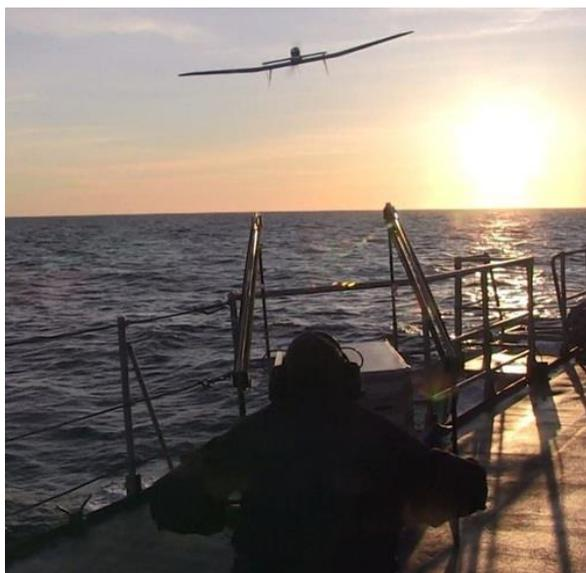
Ces drones de 16 kilos sont propulsés par un moteur électrique. Lancés à partir d'une catapulte, ils ont une autonomie de trois heures. En fin de vol, leur récupération à bord s'effectue automatiquement dans un filet.
